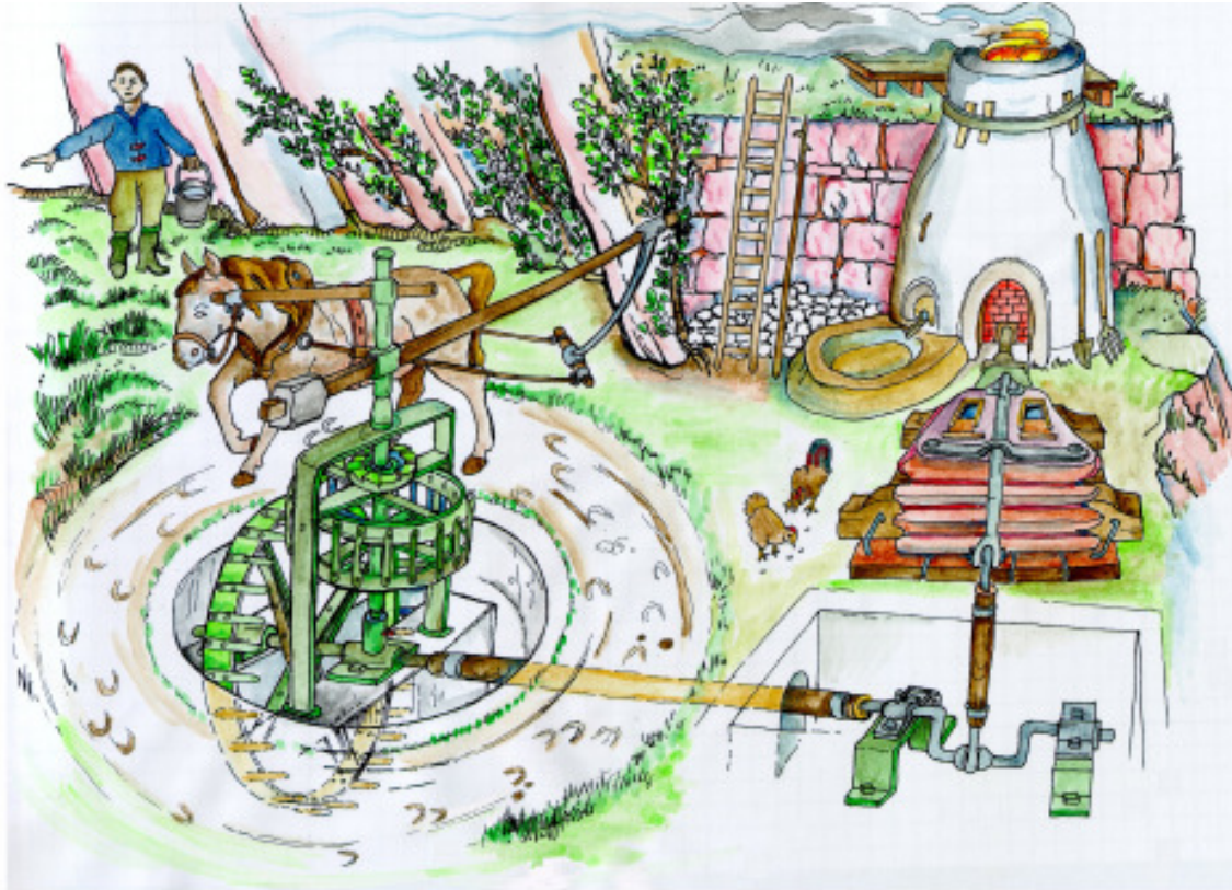
Abb. 24: Rennofen mit Göppelwerk und Blasbalg
