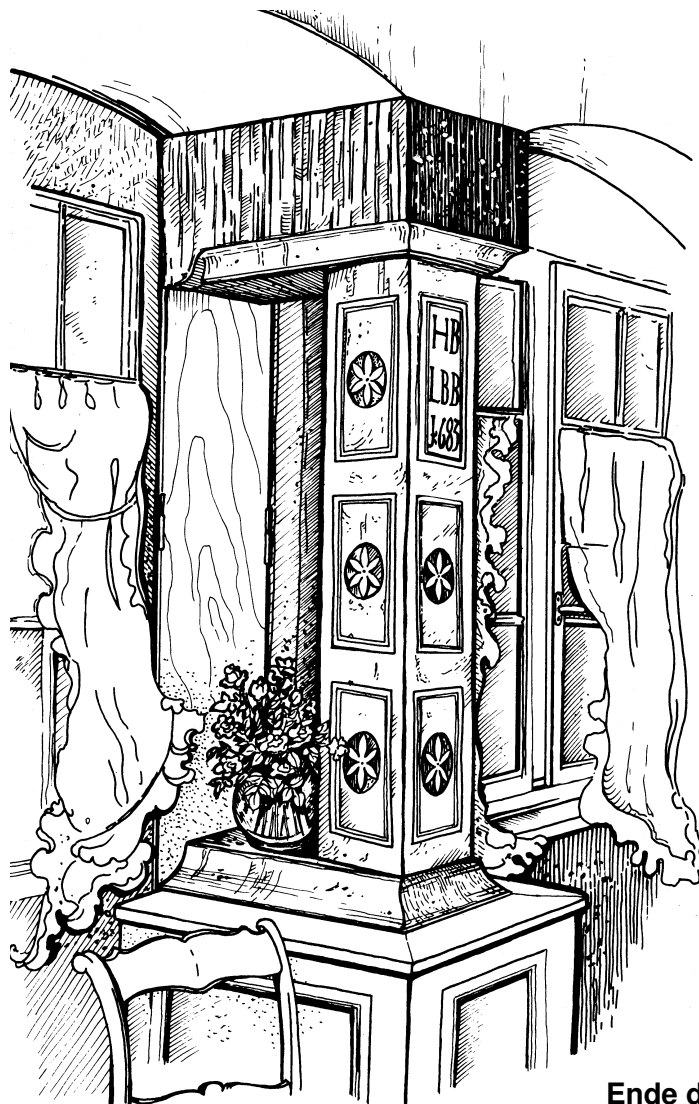
Das Vierfachfenster auf der Rheinseite in vergrößerter Darstellung. Es hat zwei schmale Stege an den Seiten und einen verstärkten Mittelsteg. Durch die beiden Fliegenschutzgitter ist die Fensterumrandung teilweise verdeckt.
